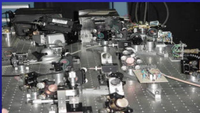
**Sistema Óptico de la Trampa Magneto-Óptica del CENAM**
