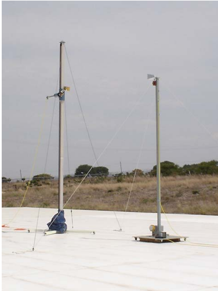
Calibración de una antena de corneta de doble cresta en el intervalo de 1 GHz a 20 GHz en el CALTS-CENAM a una distancia de prueba de 3 m.
