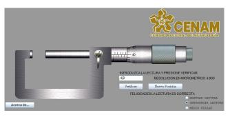
Fig. 3. Virtual micrometer
