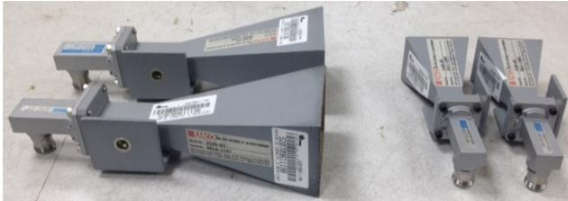
**Figura 6.** Conjunto de antenas de corneta físicamente pequeñas para el intervalo de 8.2 GHz a 12.4 GHz y de 12.4 GHz a 18 GHz.
