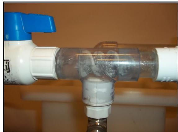
Fig. 6. Imagen del Mezclador estático.
