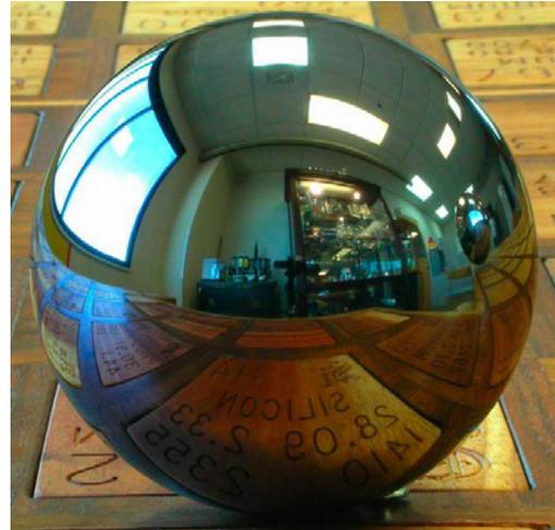
**Fig. 1** Patrón primario de densidad<sup>1</sup>
