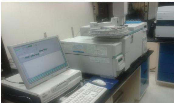
**Figura 3.** Cromatógrafo de gases acoplado a detector de espectrometría de masas. Marca: Agilent Technologies. Modelo: 6890N/5973N.
