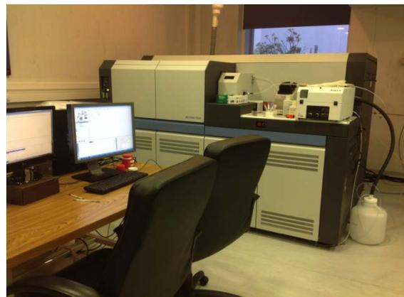
**Figura 2. Espectrómetro de masas de multicolector con plasma acoplado por inducción (MC-ICP-SFMS)**
