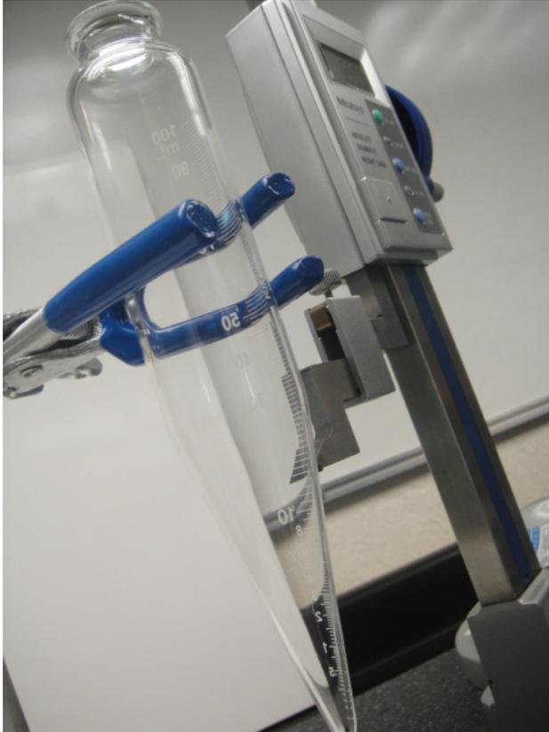
**Fig. 3.** Medición de la variable  $a$  con el medidor de alturas (tubo para centrífuga).
