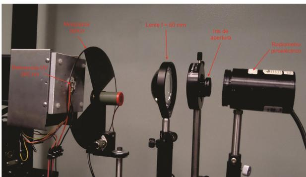
**Figura 3.** Sistema de medición con la fuente de radiación UV de estado sólido a 365 nm.
