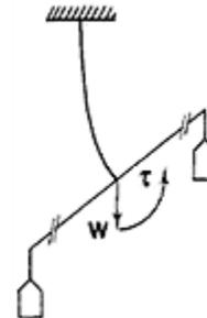
Figura 3. Esquema de un pivote flexible ubicado al centro de una viga, se muestra la deformación del elemento dada por un torque  $\tau$  cuando se encuentra bajo una carga  $W$ .
