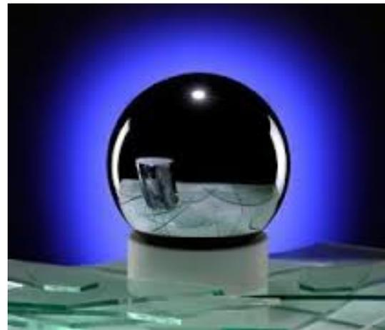
**Fig. 10** Esfera de Silicio, redondez de aproximadamente  $1,2\ \mu\text{m}$
