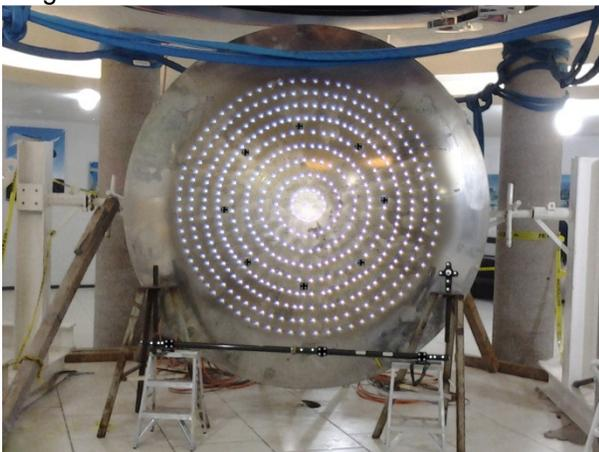
**Fig. 2.** Medición del M2 con fotogrametría.
