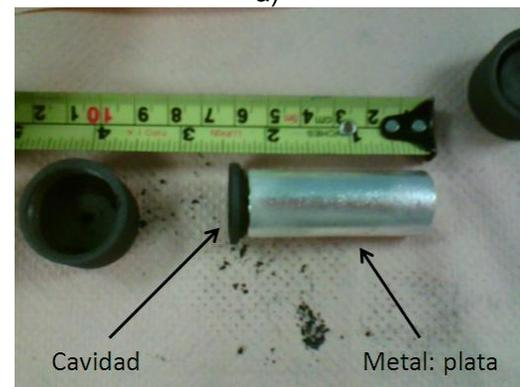
**Fig. 3.** a) Horno eléctrico empleado para colocar plata en el interior del crisol, y formar la unidad CN-Ag, b) la cavidad, fuera de la unidad, envuelta por plata.
