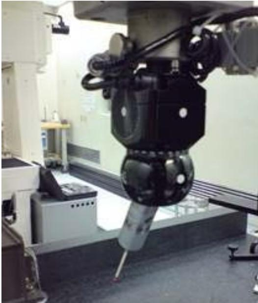
**Fig. 3.** Cabezal con las tres motas de referencia y palpador visibles
