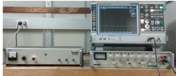
**Figura 10.** Configuración para la medición de los niveles en tensión en c.c. para la calibración vertical del osciloscopio.
