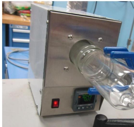
**Fig.3.** El horno tiene dimensiones aproximadas de 19.0 cm x 21.0 cm x 13.5 cm y una masa de 2.8 kg.
