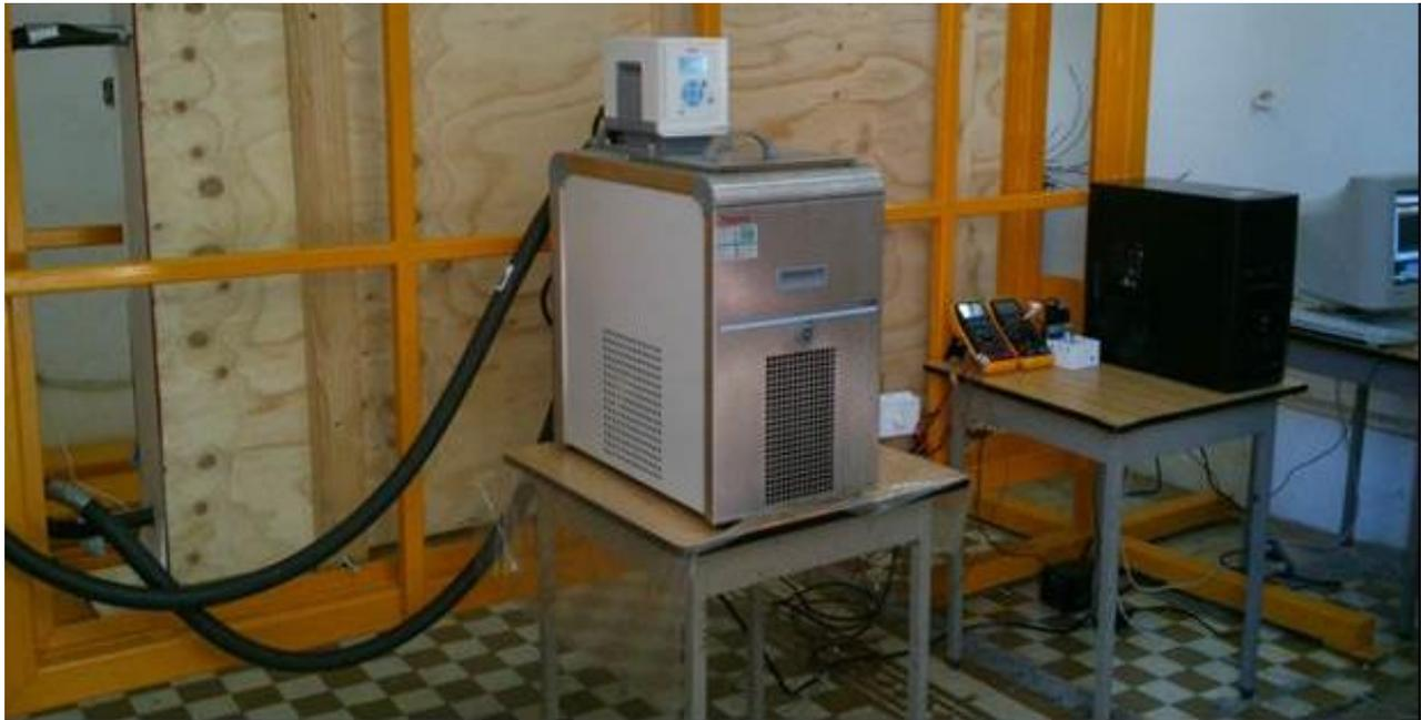
**Fig. 7.** Equipo para medir la conductividad térmica. Fuente: Propia.
