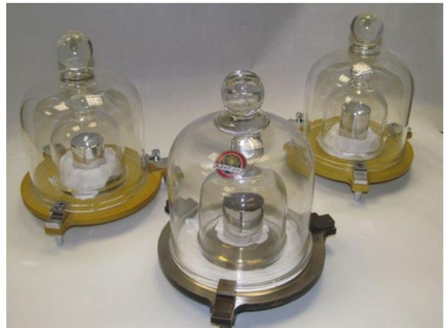
**Fig. 6** Patrones de Platino Iridio, k90, k21 y k96, mantenidos en la Dirección de Masa y Densidad del CENAM.
