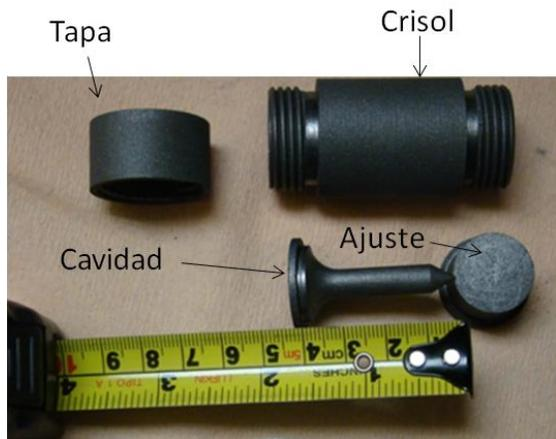
**Fig. 2.** Partes de la unidad CN-Ag: una cavidad cilíndrica, un crisol, ajuste y una tapa en cada extremo del crisol.
