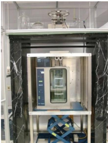
**Fig. 5 1er.** Sistema de medición de pesada hidrostática para patrones sólidos de densidad CENAM
