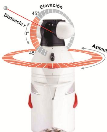
Fig.3 Coordenadas polares del Láser Tracker.
