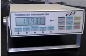
**Fig. 2.** Termómetro digital de cinco canales.
