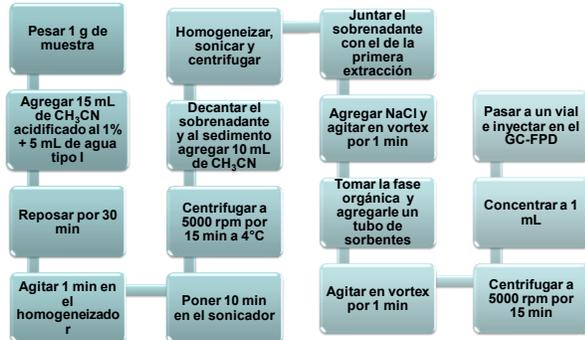
Figura 1. Diagrama de Bloques del proceso de extracción
