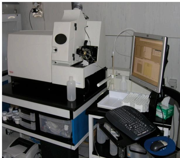
**Figura 1.** Espectrómetro de masas de cuádruplo Thermo X series II (QICP-MS)
