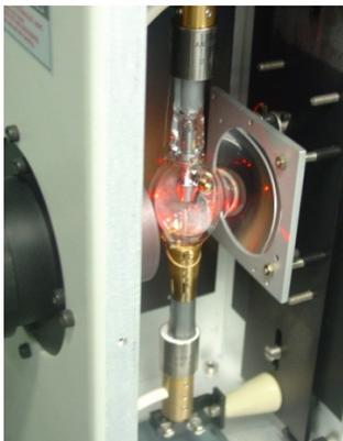
Figura 1. Lámpara de descarga de Hg(Xe).
