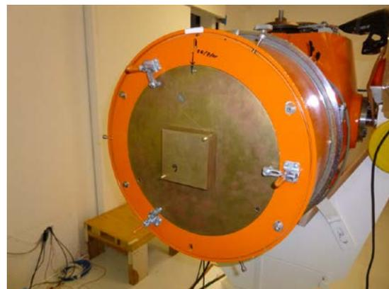
**Fig 5.** Láminas de latón montadas en el irradiador Picker C9 para la atenuación de la tasa de kerma
