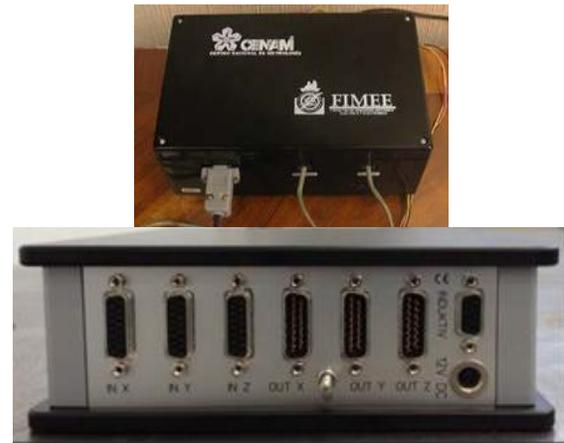
**Fig. 4** Arriba, hardware de corrección geométrica para CMM manual desarrollado en CENAM. Abajo, hardware de corrección geométrica comercial para cualquier CMM.
