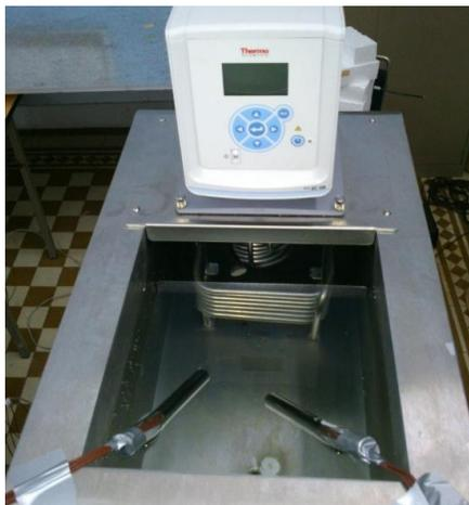
Fig. 2. Calibración de termopares utilizando baño térmico. Fuente: Propia.
