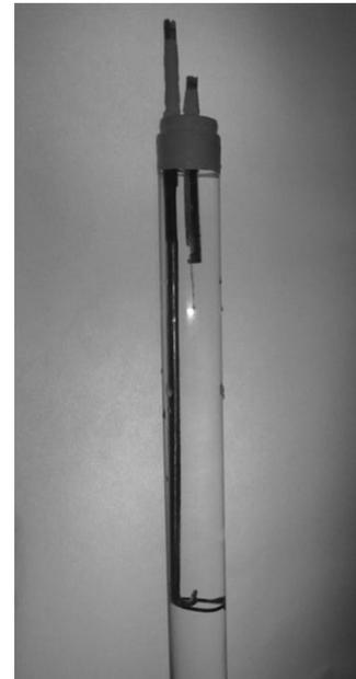
**Fig. 4.** Celda de vidrio y alambre de platino.
