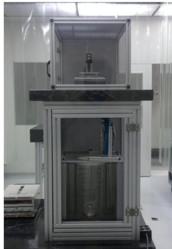
Fig. 8 Sistema de Pesada hidrostática para la determinación de densidad de líquidos
