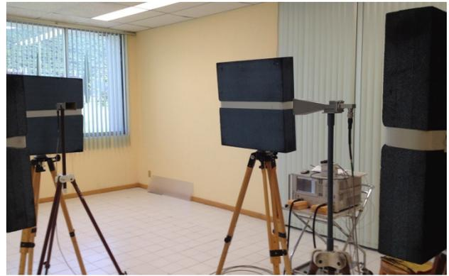
**Figura 7.** Sistema de medición para el conjunto de antenas de la figura 6. Se utilizan esponjas que absorben el campo electromagnético a fin de eliminar las posibles reflexiones y tener condiciones de espacio libre.
