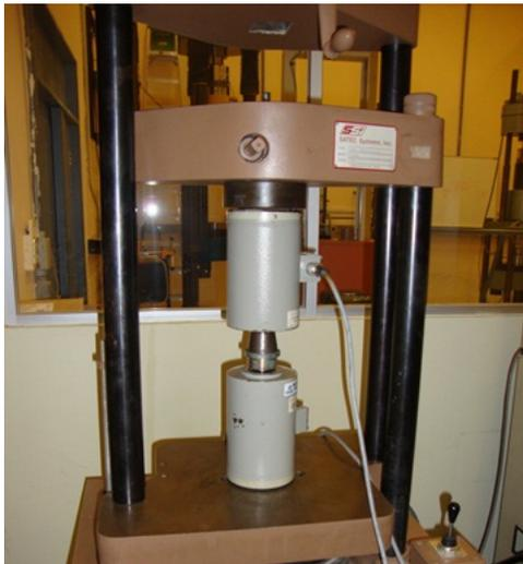
**Fig. 2.** Máquina de ensayos utilizada para la comparación, con un transductor de fuerza instalado en el cabezal superior de la máquina.
