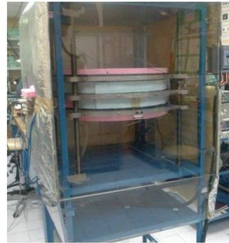
**Fig. 3.** APCG para materiales de construcción.
