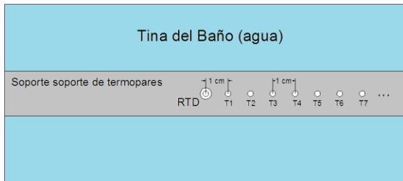
**Fig. 2.** Diagrama de pruebas de medición. Mediciones realizadas hasta 15 cm de separación.
