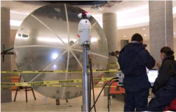
**Fig. 1.** Medición del M2 con Láser Tracker.
