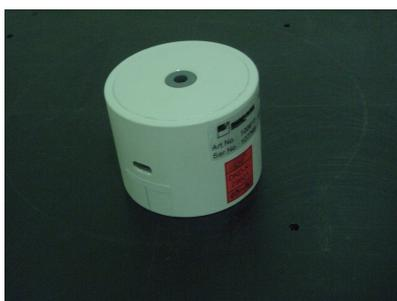
**Fig. 8:** Imán patrón con cavidades para medir flujo axial y flujo transversal, con un valor nominal de 100 mT.
