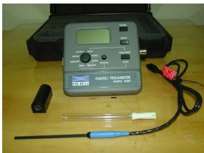
**Fig. 2:** Magnetómetro digital con sonda de efecto Hall
