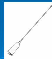
Los monopolos se alimentan mediante una línea coaxial con el conductor central conectado a la antena y el conductor exterior a un plano de tierra. A los monopolos delgados, es decir aquellos con radio mucho menor que su longitud, se les considera como independientes del plano de tierra, pero para dipolos muy gruesos como los rodillos la distribución de corriente en la antena depende del radio del plano de tierra.
