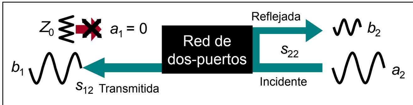
Coeficiente de reflexión de salida  $\Rightarrow S_{22} = \left. \frac{b_2}{a_2} \right|_{a_1=0}$
