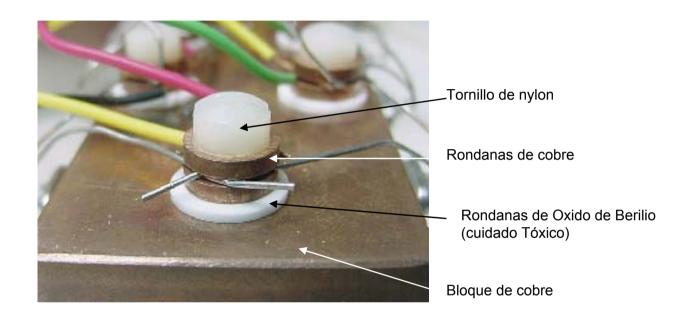
Bloque de cobre para conexiones de bajas fems térmicas
