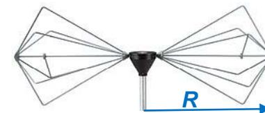
30 MHz  $\rightarrow \lambda = 10$  m  $\therefore$  pruebas a 1 m con biconica de 1.37 m en región de campo cercano
