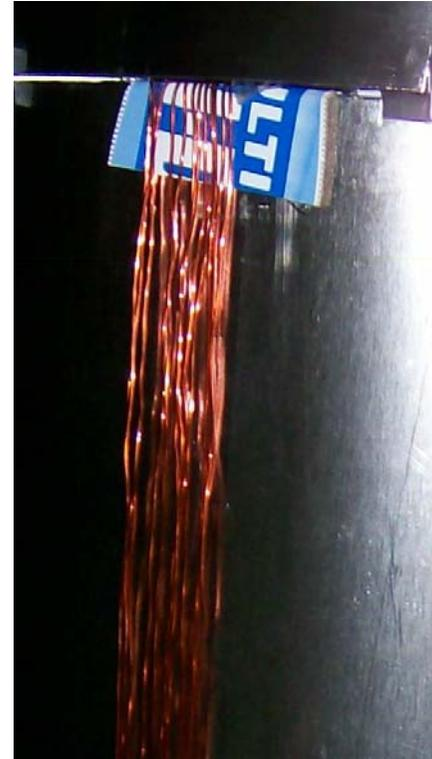
La demagnetización se logra al pasar una corriente alterna de 60 Hz, variando la tensión desde 5 hasta 25 Volts, durante 10 minutos.
