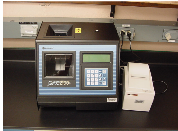
Figura 1. Medidor de contenido de humedad en granos basado en el principio de capacitancia eléctrica.
