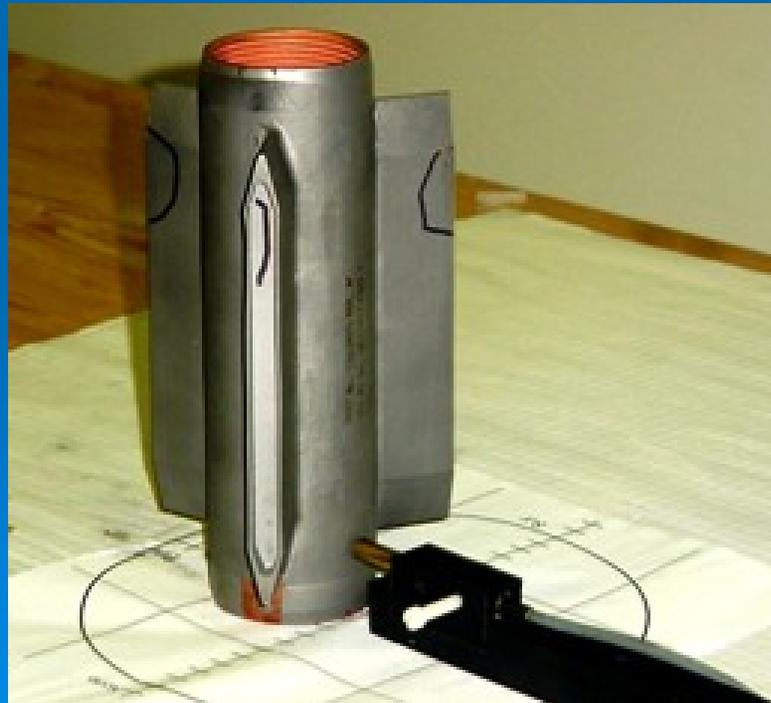
4.- Se retira la pieza o material sujeto a medición y se mide nuevamente el campo magnético ambiental. Se realizan 6 mediciones y se registran en la tabla, en la columna titulada  $B_{\text{ambiental}}$  después.
