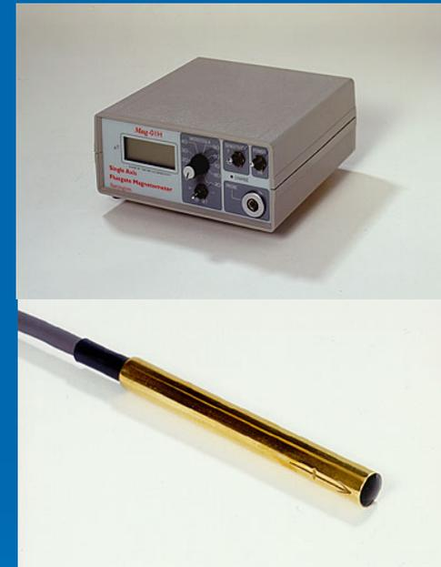
Para estas mediciones se coloca el sensor en la posición de interés, en la posición de referencia donde se midió el mínimo campo magnético ambiental (Dirección: este-oeste)
