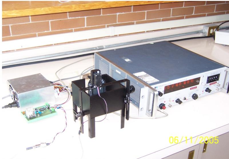
El sistema está conformado por un equipo patrón generador de la base de tiempo (HP 5245M), un circuito electrónico acondicionador de las señales de salida del generador y un dispositivo mecánico de sujeción para el conjunto servomotor y cronómetro. En el circuito electrónico se tiene un relevador, el cual acciona el servomotor y cuando gira su eje desplaza una leva la cual realiza la acción de oprimir el botón de arranque y paro del cronómetro.
