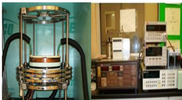
**Figura. 1.** Aparato de placa caliente con guarda
