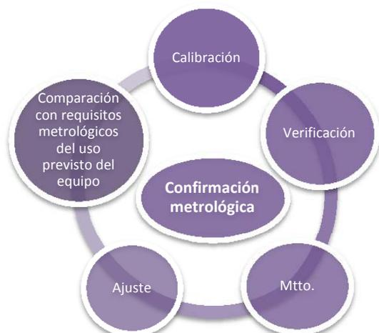
**Figura 2.** Elementos de la Confirmación Metrológica.
