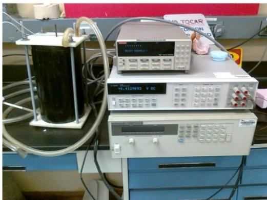
Figura 3. Sistema para el método de barras concéntricas cortadas.
