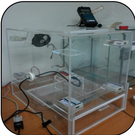
**Fig. 1.** Cámara diseñada para el sistema de calibración.
