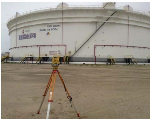
**Fig.4.** Toma de lecturas ópticas con Estación Total
