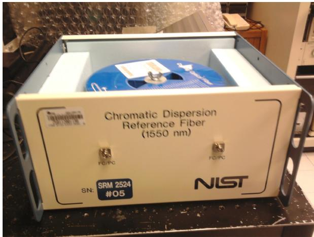
**Fig. 2.** Bobina de fibra óptica de dispersión desplazada G.653.
