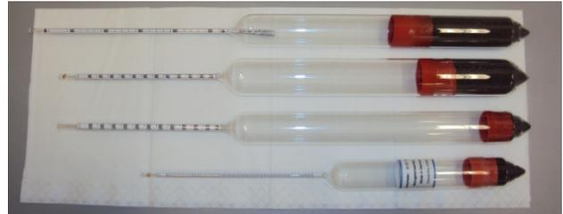
**Fig. 2.** Hidrómetros, densímetros de inmersión.
