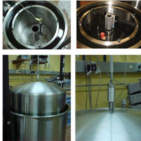
Figura 4. Fotos de rediseño del volumen del anillo cilíndrico y del cable
