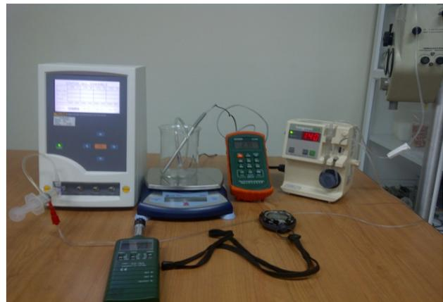
**Fig. 2.** Montaje en el laboratorio de Metrología Biomédica, por medio Gravimétrico
