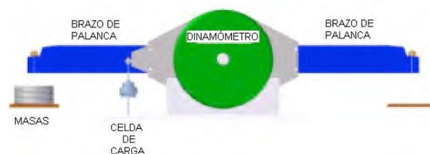
Figura 1. Dibujo esquemático de un dinamómetro.
