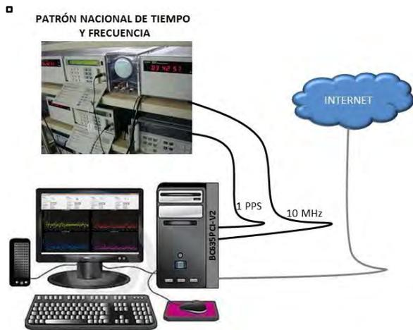
**Fig. 5.** Diagrama esquemático del sistema de medición incluyendo la tarjeta BC635PCI-V2.
