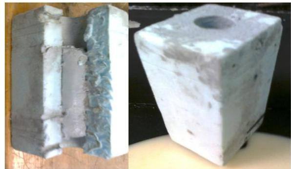
**Figura 7. Preparación de la muestra para el SBCC.**
