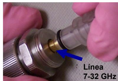
**Fig. 12.** Línea de transmisión "ID 7-32 GHz".
