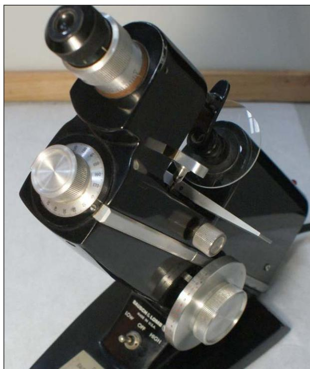
**Fig. 7:** Frontofocómetro
