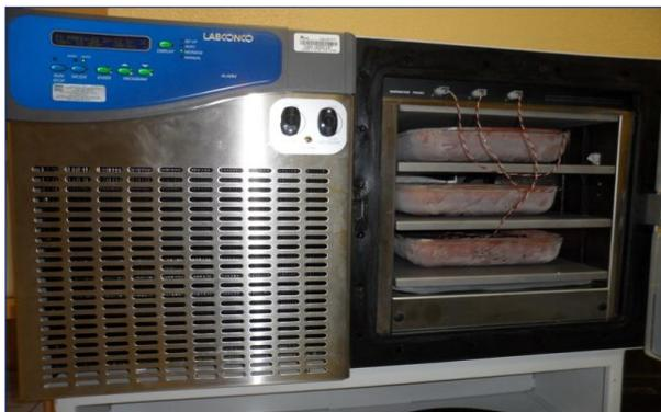
**Fig. 3.** Proceso de liofilizado del músculo de bovino molido.
