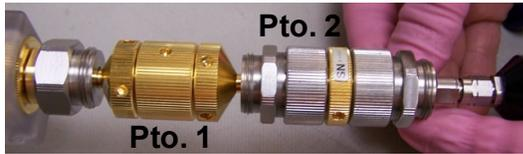
**Fig. 13.** Conexión Thru-cero
