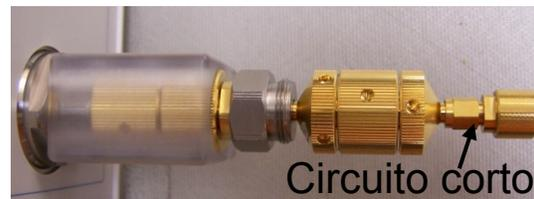
**Fig. 6.** Conexión del circuito corto -Macho-
