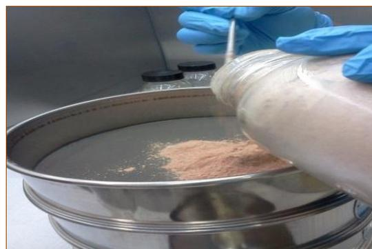
**Fig. 6.** Tamizado del músculo de bovino liofilizado y molido.
