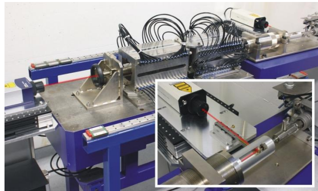
Fig. 5. Dispositivo para la calibración con fuerzas de choque hasta 20 kN en el PTB.
