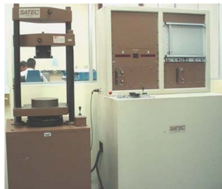
Figura 1. Máquina de ensayos utilizada en el ensayo de aptitud CENAM-EA-720/F.01.
