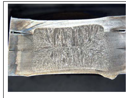
Fig. 10 Evaluación de fusión de soldadura usando microscopía
