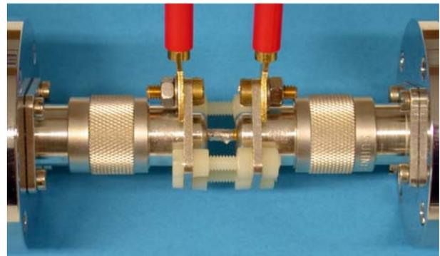
Fig. 1. Conexión en serie simétrica de dos patrones de transferencia de corriente con mínima capacitancia
