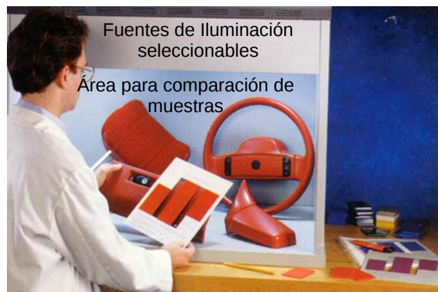
Fig. 1 Ejemplo de una cabina de iluminación para comparación de color.
