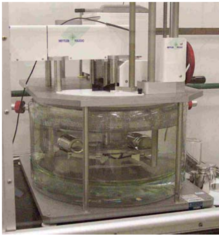
Fig. 2 Sistema comparador de volumen de pesas patrón por Pesada Hidrostatica del Laboratorio de Masa
