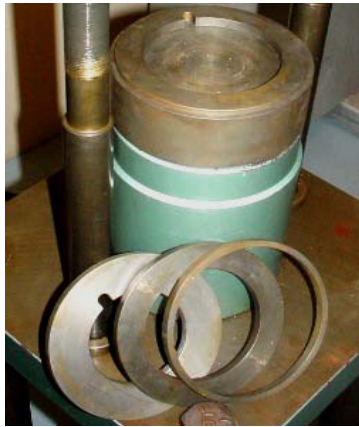
Figura 5. Base universal para celdas de carga utilizadas en las máquinas de transferencia.
