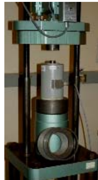
Figura 8. Celda de carga instalada en la máquina de transferencia de 500 kN y anillos de centrado.
