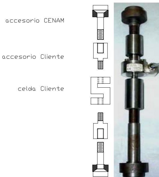
Figura 13. Instalación de equipos para servicios en tracción.
