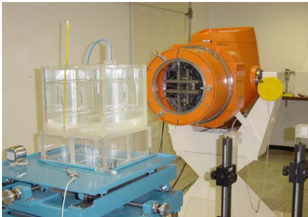
Fig. 1 Irradiador Picker C9 de ^{60}\text{Co} y cámara BEV CC01-131 sumergida en maniquí de agua
