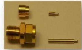
*A la izquierda y derecha de la imagen, se observan los conductores exterior e interior de un par de líneas coaxiales de precisión de 3.5 mm, que tienen un dieléctrico de aire, y que forman parte del patrón primario de medición de coeficientes de reflexión y transmisión hasta 32GHz*
