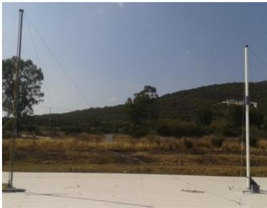
*Antenas patrón de medición posicionadas sobre el Sitio de Calibración de Antenas (CALTS) a campo abierto, durante el proceso de medición de sus parámetros de referencia.*
