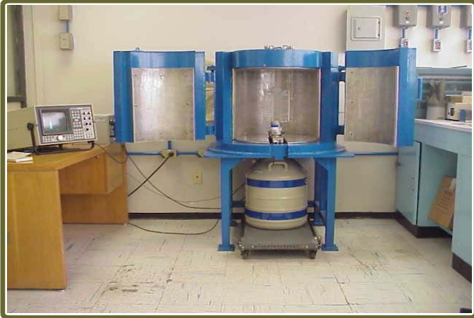
Patrón Nacional de actividad nuclear, el detector blindado con plomo-hierro-cobre-acrílico; y el sistema de amplificación, conversión analógica-digital y analizador multicanal .
