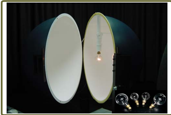
Patrón Nacional de Flujo Luminoso Total (Lámparas patrón y sistema de esferas de integración)
