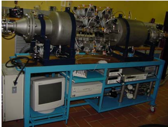
Fig.1 Fotografía del banco de toberas de flujo crítico. Dirección de flujo de derecha a izquierda.
