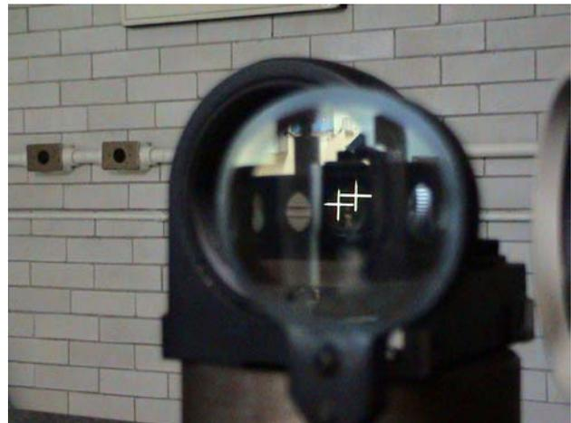
**Fig. 3 Vista de los haces "A" y "B" reflejados a través del divisor de haz.**
