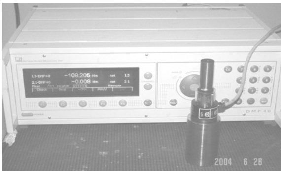
Figura 1. Ejemplo de un instrumento de medición de par torsional e indicador digital.
