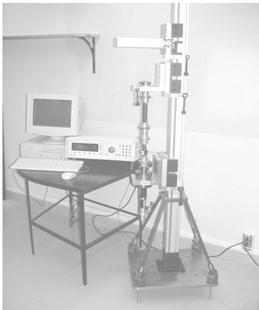
Figura 7. Sistema de referencia para medición de par torsional de bajo alcance (0,1 Nm a 10 Nm).
