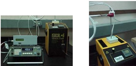
Fig. 5. Sistema de calibración en temperatura
