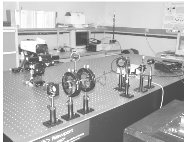
Fig. 3 Arreglo experimental de Interferómetro Michelson en Cuadratura
