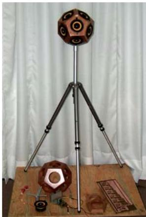
**Fig. 2** Fuente Sonora Omnidireccional montada en un tripie y partes que la conforman.
