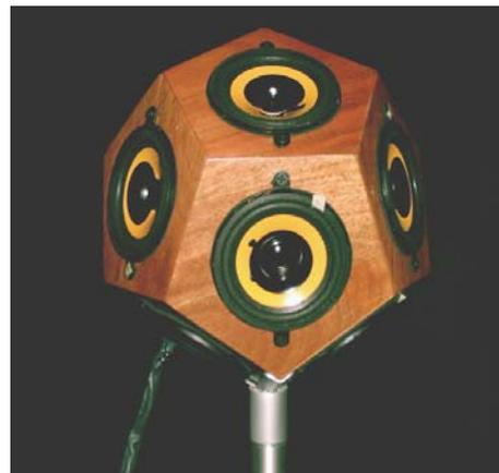
**Fig. 1** Prototipo de Fuente Sonora Omnidireccional, en forma de Dodecaedro, desarrollada en el LAV-CCADET-UNAM.
