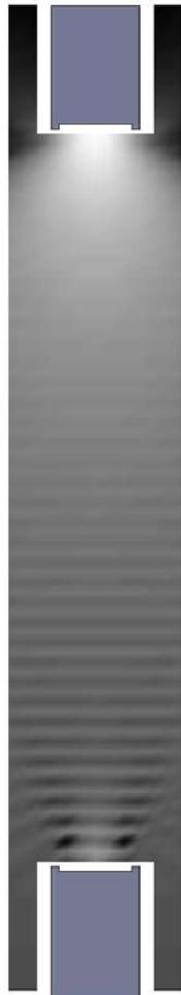
**Figura 5.** Campo acústico creado entre dos micrófonos LS1 separados 200 mm, a 20 kHz.
