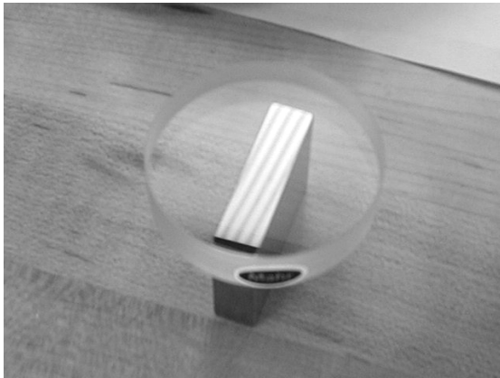
Figura 2.- Medición de planitud por medio de un plano óptico.
