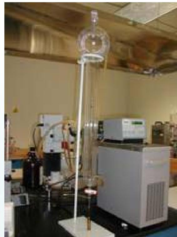
Se coloca en una bureta con chaqueta de enfriamiento conectado a recirculador de enfriamiento a una temperatura de 4°C
