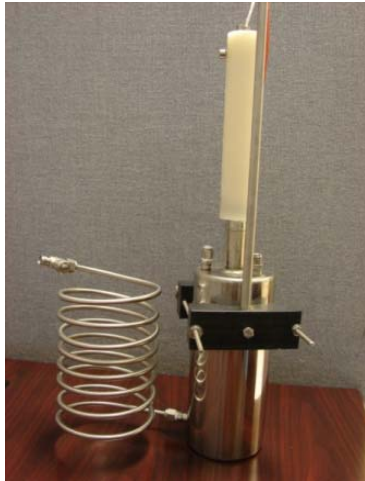
Fig. 1. Cámara con serpentín para el acondicionamiento térmico de aire.
