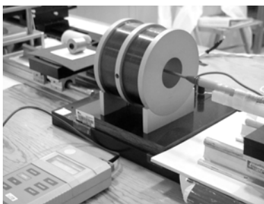
Fig. 2. Bobina patrón tipo Helmholtz utilizada para la calibración de magnetómetros, por el método de comparación directa.
