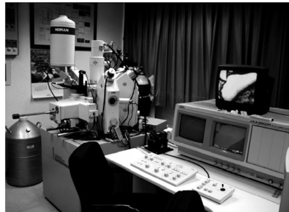
Fig. 1 Microsonda electrónica JEOL 8900R
