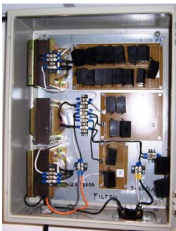
Fig. 7. Fotografía del filtro de armónicas.
