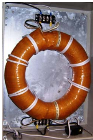
Fig. 11. Fotografía del transformador de aislamiento ya montado.
