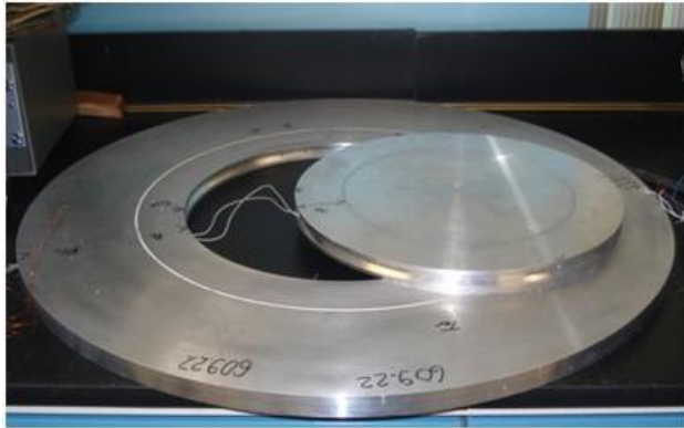
Figura 3. Placa guarda y placa de medición que forma la placa caliente.
