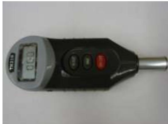
**Fig. 1** Medidor de dureza Shore escala D (HD)
