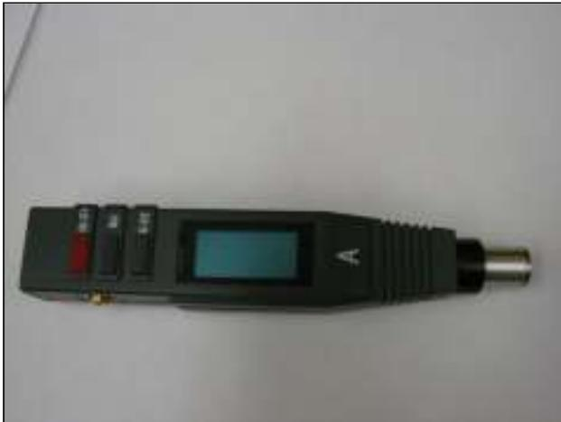
**Fig. 2** Medidor de dureza Shore escala A (HA)
