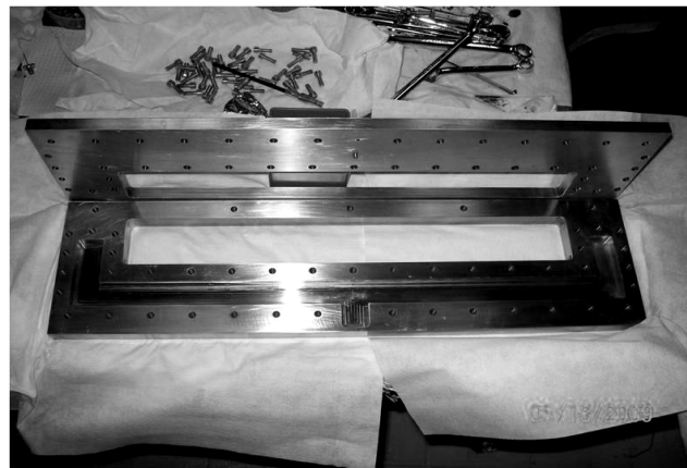
Fig. 2 Fotografía de la cavidad de Ramsey, fabricada en cobre electrolítico para el reloj de haz térmico CsOP-2.
