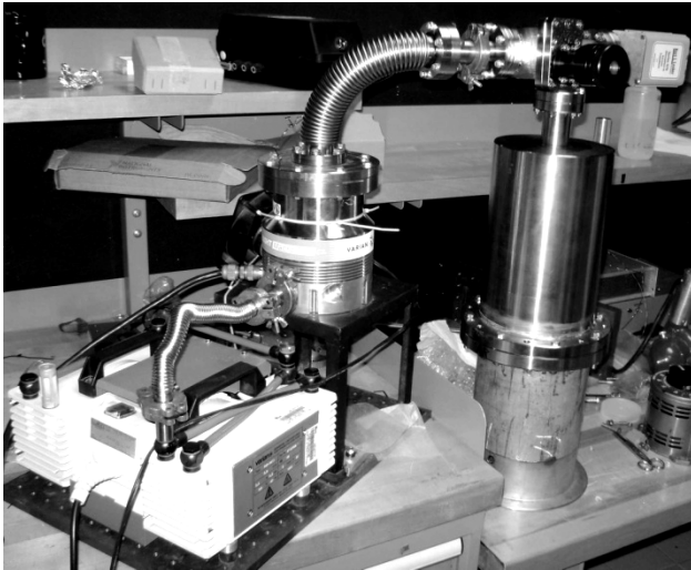
Fig.6 Cámara de vacío conectada a una bomba turbomolecular, asistida por una bomba mecánica. En el interior de la cámara se introdujeron las cavidades de microondas de la fuente de átomos CsF-1.
