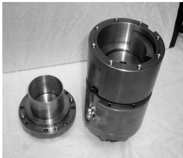
Fig. 5. Fotografía de las cavidades de microondas usadas para la medición del índice de refracción del aire. Las cavidades se muestran acopladas tal como operan dentro del reloj de fuente de átomos CsF-1
