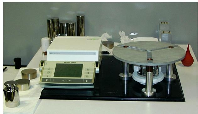
**Fig. 7** Susceptómetro de 50 kg instalado en el comparador Mettler MX5.
