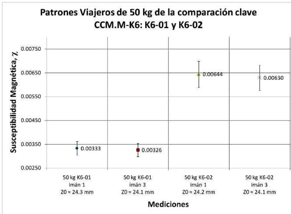
Fig. 12 Resultados de pesas de 50 kg K6-01 y K6-02 con susceptómetro de 50 kg.
