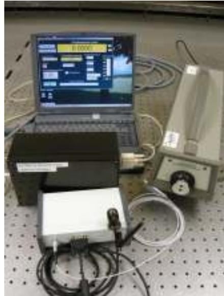
**Figura 5.-** Sistema interferométrico desarrollado, mostrando los módulos de conteo e interpolación, compensación ambiental, fuente láser y programa de medición.
