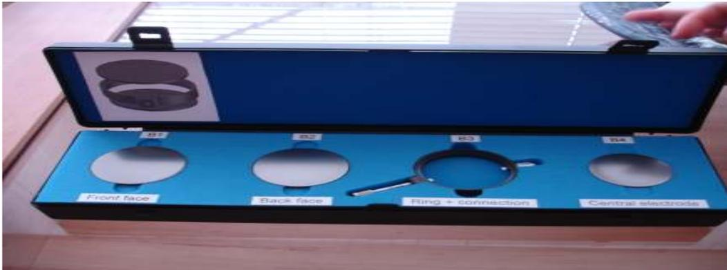
**Fig. 2** Piezas que componen la cámara patrón primario modelo CH construida en el BIPM para el ININ.
