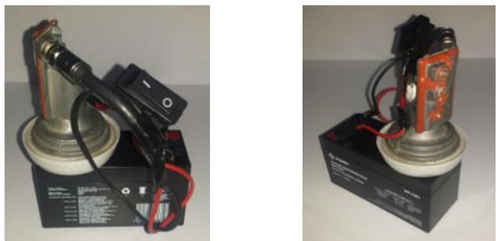
**Fotos 1 y 2** LNB, con una batería de 12 Vcd e interruptor
