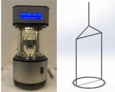
**Fig. 1.** Tensiómetro y anillo utilizados.
