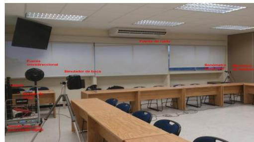
**Fig. 1.** Instrumentación empleada en la determinación del índice de inteligibilidad del habla.
