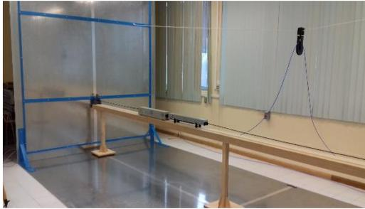
**Fig. 1.** Estructura del PNCE en frecuencias de 30 MHz a 300 MHz.
