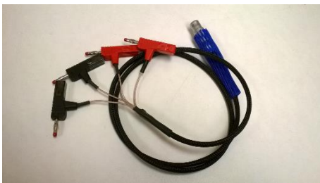
Fig. 1. Cables coaxiales con terminación Banana.
