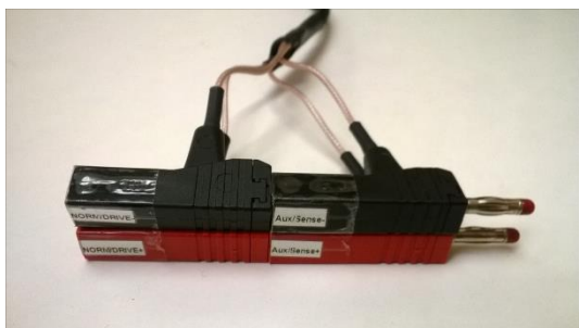
Fig. 3. Circuito abierto con terminales juntas.
