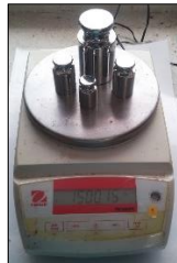
Fig. 2. Balanza digital (Cap.: 1500 g; Res.: 0,01 g)
